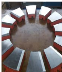
SAPATAS DE ESCORA DA TURBINA FRANCIS
