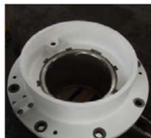
MANCAL DA TURBINA FRANCIS PERTENCENTES À UHE
